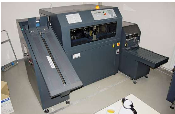
Neueste Anschaffung aus dem Hause FKS ist der vollautomatische Dreiseitenschneider FKS/Challenge CMT-130. Besonders hilfreich: die Stapelanlage (l.).
